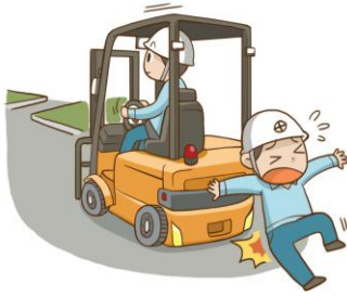
운전자 시야불량, 운전미숙, 과속에 의한 부딪힘 위험
