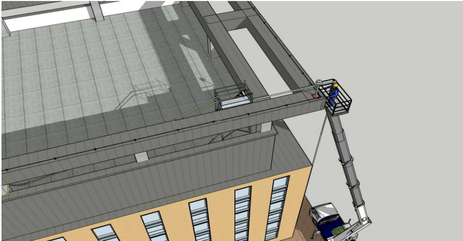
<2안 : 차량 탑재형 고소작업대 활용(고위험 캔틸레버 구간에 한함)>
